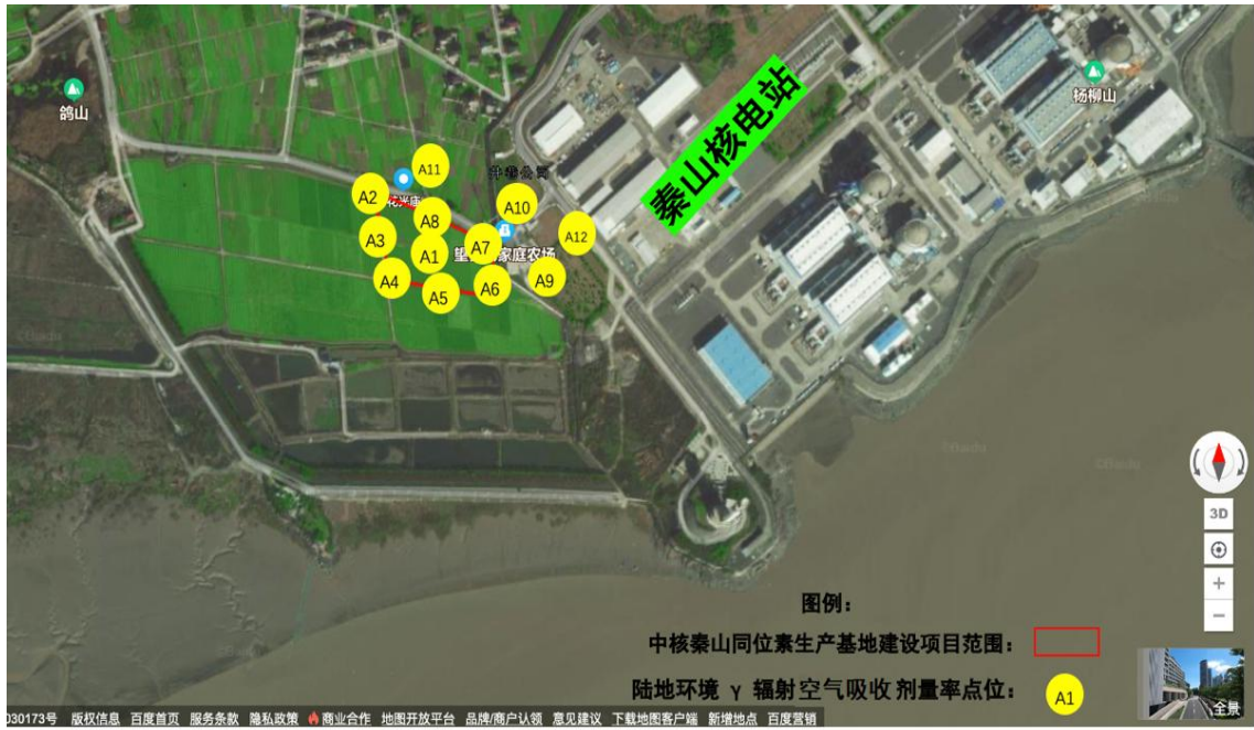
图 2-2 场址 50m 范围内环境γ辐射空气吸收剂量率检测布点示意图
